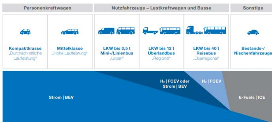
Abb.: Antriebsportfolio der Zukunft (Fokus: Straßenverkehr), Quelle: VDE Verband der Elektrotechnik Informationstechnik e. V.
